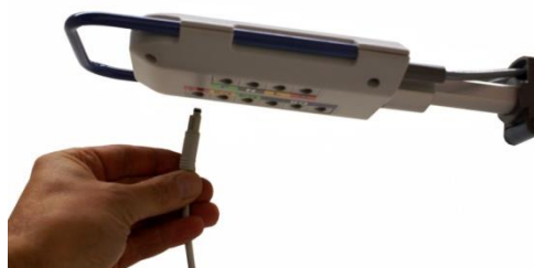
Elektrodenleitungen am Verteiler entsprechend den Codierungen einstecken.
