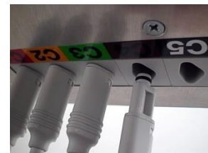
Elektrodenleitungen am Verteiler entsprechend den Codierungen einstecken.
