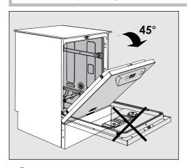
Öffnen Sie die Tür etwa im 45° Winkel. Auf diese Weise gelangt das Salz optimal in den Vorratsbehälter.
