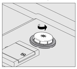
■ Schrauben Sie den gelben Verschlussdeckel mit dem ※ Symbol in Pfeilrichtung auf.
