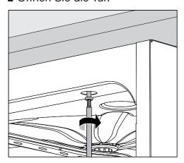
Verschrauben Sie den Reinigungsautomat links und rechts durch die Löcher der vorderen Leiste mit der durchgehenden Arbeitsplatte.
