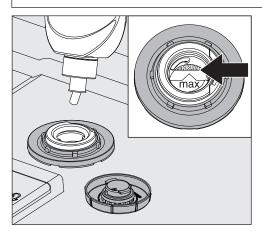
■ Füllen Sie den Klarspüler so lange ein, bis dieser an der mit "max." gekennzeichneten Einfüllkante im Einfülltrichter sichtbar wird.
