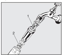
Die im Beipack mitgelieferten Großflächensiebe zwischen Absperrventil und Zulaufschlauch installieren. Das Großflächensieb für AD-Wasser ist aus Chrom-Nickelstahl, zu erkennen an der matten Oberfläche.
