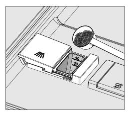
■ Füllen Sie den Reiniger in die Behälterkammer.
