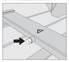
■ Tauschen Sie für die Spüldruckmessung die Blindschraube gegen einen Luer-Lock Adapter, z. B. E 447, aus.
