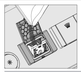
Auf keinen Fall Wasser in den Vorratsbehälter füllen! Der Vorratsbehälter könnte beim Salzeinfüllen überlaufen.
