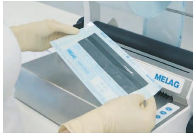
Der **täglich** durchzuführende **MELAcontrol Seal Check** verifiziert die Qualität der Siegelnaht nach DIN EN ISO 11607-2.
