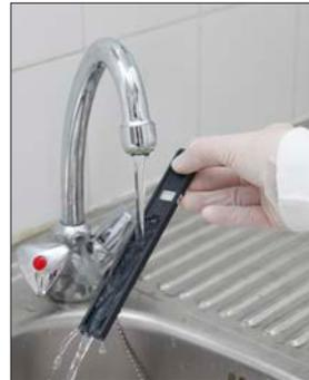
Abb. 23: Reinigung des Teststreifenhalters
