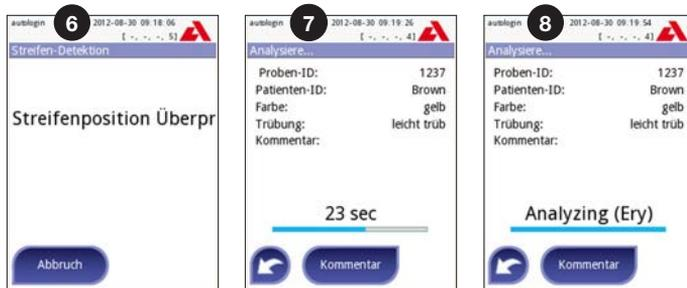
6. Die Lage des Teststreifens wird vor Messstart überprüft.
